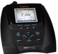
Mida de forma fiable pH, mV, ORP y temperatura con el medidor de pH de sobremesa Thermo Scientific Orion Star A211 para los análisis de laboratorio avanzados y la interfaz con impresoras u ordenadores.
