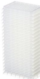
Logre una recuperación de muestras completa con las placas MicroWell™ de polipropileno de 96 pocillos Thermo Scientific Nunc, las cuales son ideales para el almacenamiento dado que el polipropileno tiene una menor capacidad de unión y las proteínas o el ADN no se unen. Admiten temperaturas de -80° a + 121 °C. Disponibles en varios colores para la identificación rápida de las placas de almacenamiento.
