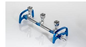
Colector de microbiología diseñado para ofrecer flexibilidad y reducir la contaminación cruzada.
