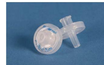
Diseñado para el análisis de rutina diario. El filtro de jeringa de PTFE no estéril Fisherbrand incluye una membrana de PTFE hidrófoba para la filtración de soluciones orgánicas para HPLC. Disponible en dos diámetros de membrana (13 y 25 mm) y dos tamaños de poro (0,2 y 0,45 µm)..
