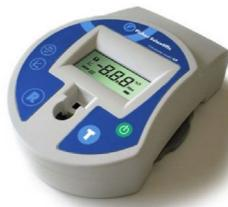
Instrumento robusto y fácil de usar dedicado a la medición de la densidad de células en suspensión como *E. coli*, levaduras, células y otros cultivos celulares.
