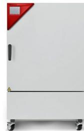
Las cámaras climáticas constantes de la serie KBF funcionan dentro de un intervalo de temperatura de entre 0°C y 70°C, y un intervalo de humedad de entre 10 % de HR y 80 % de HR.
