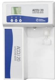
El sistema de agua ultrapura Fisherbrand Accu20 produce agua ultrapura tipo I y agua de OI directamente del agua del grifo.
