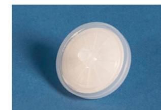
Diseñado para la filtración y purificación en un entorno estéril. El filtro para jeringa de PES estéril Fisherbrand incluye una membrana de PES en una carcasa de polipropileno para la purificación de soluciones de cultivo de tejidos de una jeringa estándar. Hay disponibles membranas de 33 mm de diámetro con tamaños de poro de 0,2 o 0,45 µm.
