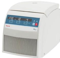
Ideal para uso diario en laboratorio, centrifugue hasta 24 tubos de microcentrífuga por ciclo con refrigeración.
