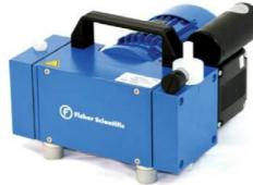
Utilice estas bombas resistentes a productos químicos para aplicaciones que impliquen disolventes agresivos y vapores ácidos. Las bombas de vacío de diafragma de politetrafluoroetileno Fisherbrand y los cabezales de conexión son de fibra de carbono reforzado para facilitar la conductividad eléctrica y evitar la carga electrostática.
