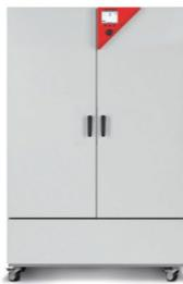
Escala de temperatura: De 0 °C a 70 °C; humedad relativa (HR): del 10 al 80 %.
