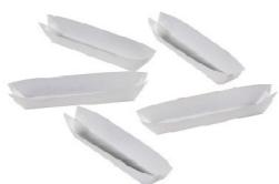
Aplicación clave: Análisis de nitrógeno. Transfiera las muestras sin pérdidas simplemente dejando caer toda la naveccilla de pesaje que contiene la muestra en la solución ácida del matraz/tubo de digestión Kjeldahl.
