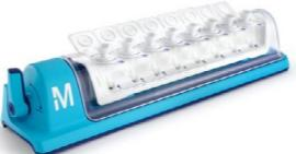
Sistema de filtración al vacío con filtros Millex para la preparación de muestras para HPLC.
