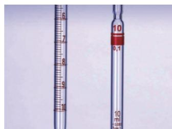
Pipetea líquidos con precisión. Las pipetas graduadas de clase AS y tipo 1 Fisherbrand™ se han fabricado con vidrio sodocálcico. Las pipetas de tipo 1 tienen la marca de cero en la parte superior.
