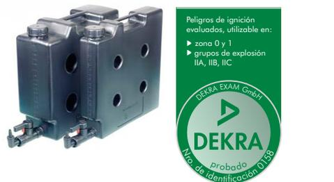
El bidón compacto hecho de HDPE conductivo está diseñado especialmente para el uso en emplazamientos a prueba de explosión. Con una resistencia superficial específica de  $<10^5$  ohmios, este bidón posee una alta conductividad. Gracias a esto, al conectarlo correctamente a tierra reduce el riesgo de incendio debido a las cargas electrostáticas. El resultado es un bidón que ayuda conformar con los requisitos de las Directivas ATEX 137, TRBS2153 y CENELEC 50404.
